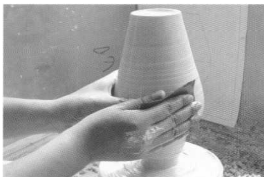
50. 用耐水砂纸蘸水进行打磨操作。打磨时要慢一点，上下移动砂纸时应该尽量匀速。
